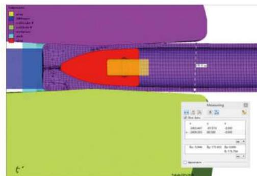
图9-14 导盘平面轧件剖面图
