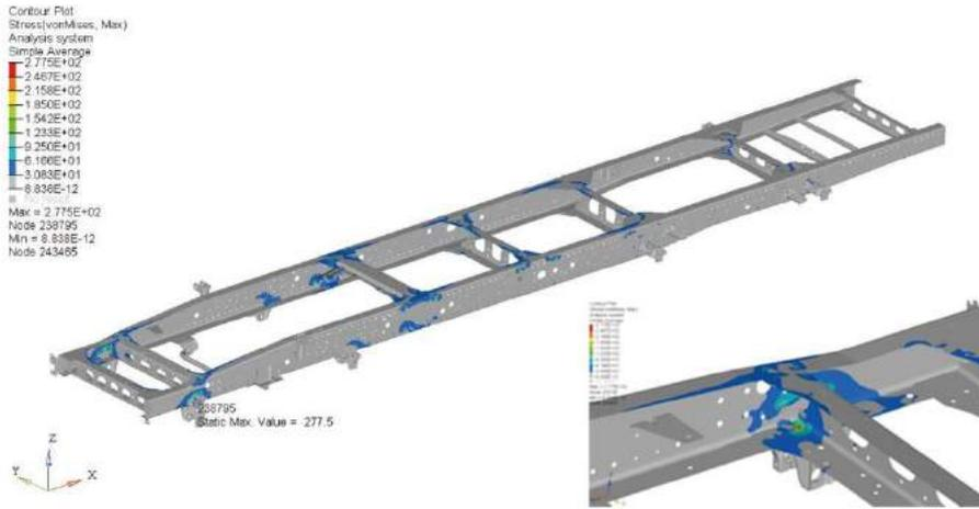
当车架右后轮抬高150mm时，车架最大应力为277.5MPa，小于材料的屈服强度500MPa，满足设计要求。
