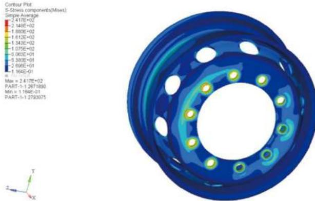
由车轮应力云图可知，在承受弯曲载荷和螺栓预紧力载荷作用时，螺栓孔处应力最大，应力峰值为242MPa，其次是通风孔处，应力峰值为108MPa。
