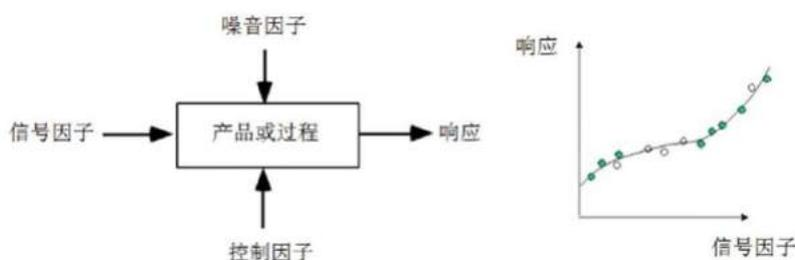
可用p-diagram系统图表明影响质量特性的参数可分为信号因子、控制因子和噪音因子三类。根据信号因子值的特点可以将系统分为如下两类：
